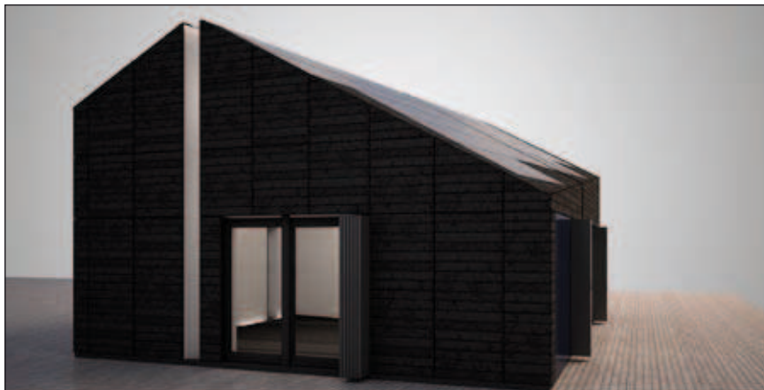
Bild 2: Westansicht des Berliner Solarhauses mit offenen Verschattungselementen mit integrierter PV
